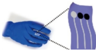
图 2 手套上的甲醇传感器
